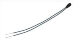
La thermistance est un élément qui permet de mesurer la température. Elle se compose d'un matériau semi-conducteur qui permet de capter tous les changements de température, même si ces derniers restent relativement faibles, grâce à une variation de sa résistance électrique.
