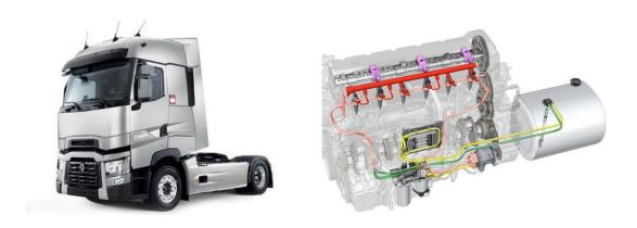
L'exploitation pédagogique prend appui sur un dossier technique lié au système d'injection à rampe commune haute pression Renault Trucks.
