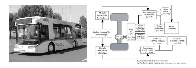
Le problème de maintenance est le suivant : « Le bus multi-hybride manque d'autonomie dans l'utilisation du système électrique de propulsion et la consommation de carburant est élevée. Les différentes parties du questionnement visent dans un premier temps à analyser le système et à définir les paramètres fonctionnels puis dans un deuxième temps à proposer les causes correspondant au dysfonctionnement énoncé ».
