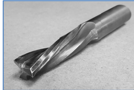
Nom : fraise de finition au carbure Spécificité : gauche Z3 Ø18 mm
