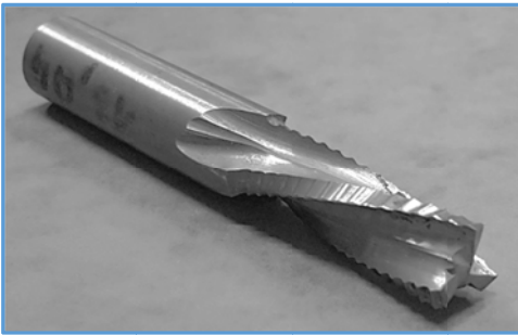
Nom : Fraise droite d'ébauche au carbure Spécificité : gauche Z3 Ø20 mm
