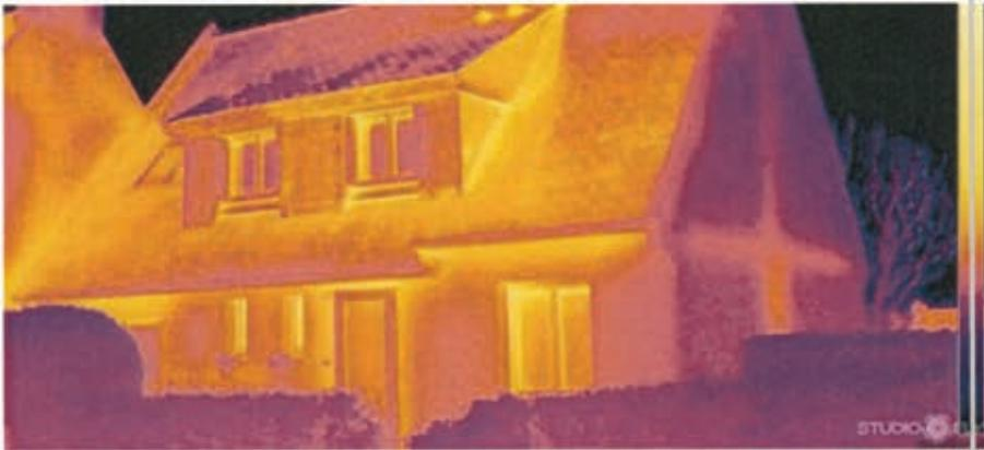
La thermographie infrarouge, ci-contre, illustre, en termes d'isolation thermique, la situation initiale du logement (température extérieure 0 °C, température des pièces du logement stabilisée à 19 °C en régime permanent), toutes ouvertures fermées. La flèche indique le sens de variation de la température selon les couleurs (dites fausses).
