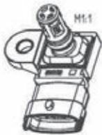
Fonction : il informe le calculateur moteur de la pression et la température dans la tubulure d'admission.
