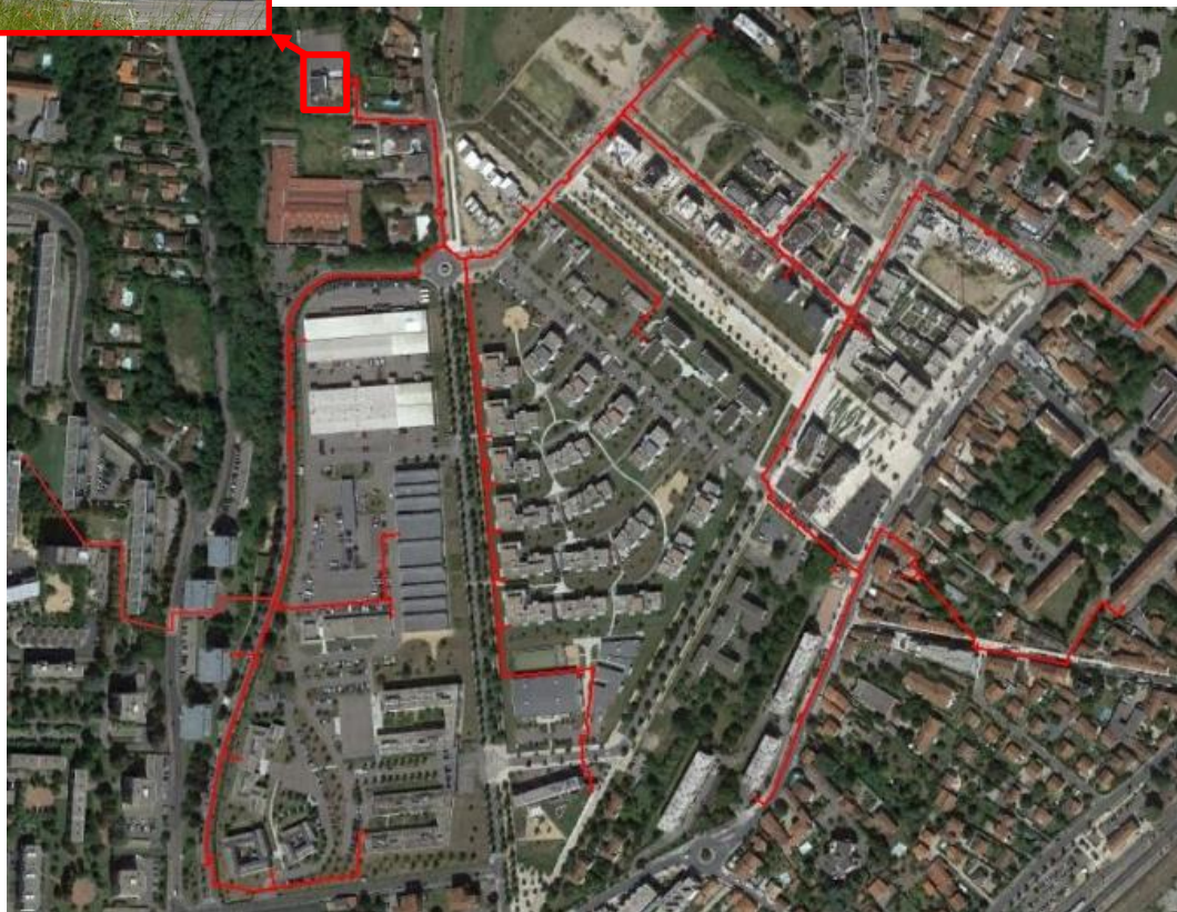
Figure 2 : Chaufferie et réseau de distribution de Sathonay
