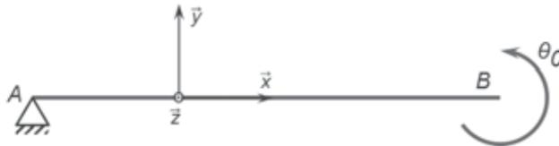
Figure 15 : modélisation d'une lame du système de suspension.
