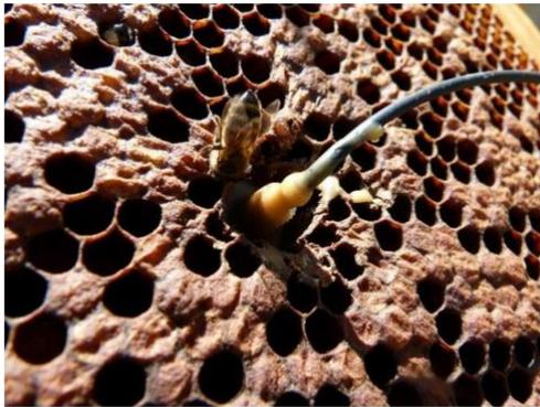
Fig. 1 : Accéléromètre piézoélectrique B&K installé au centre d'un cadre de ruche [1]
