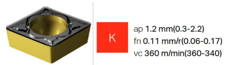
Figure 17 - Plaquette choisie et conditions de coupe recommandées pour l'usinage de l'EN-GJS-400-18 LT
