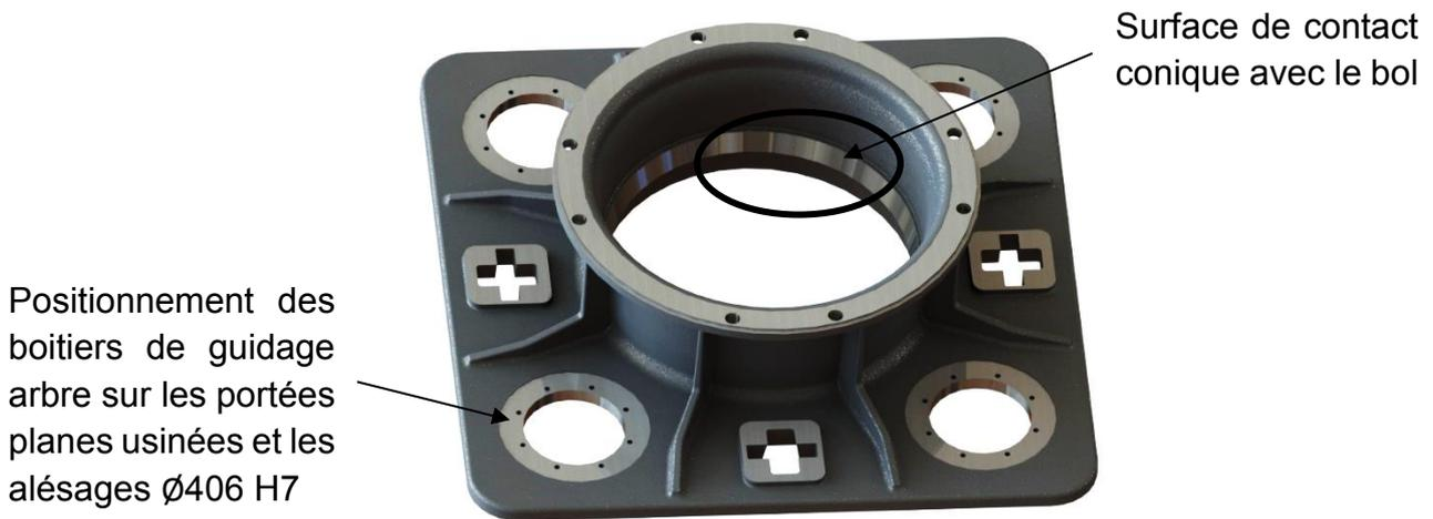
Figure 11 – Vue en rendu réaliste de l'anneau support de bol (1) (cas de brut réalisé en fonderie sable)
