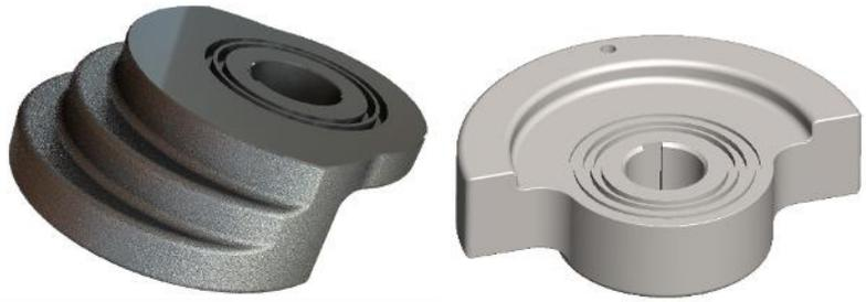
Figure 19 – Balourds inférieur (à gauche) et supérieur (à droite)
