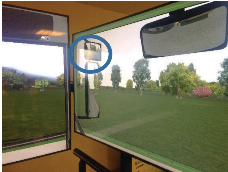
Figure 17 : le rétroviseur grand angle (entouré en bleu) permet au conducteur de contrôler le positionnement du flanc de sa cuve dans son environnement
