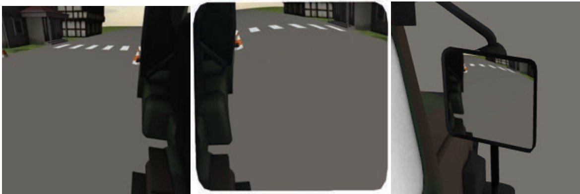
Figure 24 : à gauche, l'image rendue par la caméra, au milieu la même image après retournement et déformation, à droite l'image transformée et plaquée sur le rétroviseur
