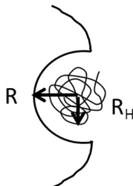
Figure 10. Représentation d'une pelote statistique dans un pore de la phase stationnaire ( $R$  est le rayon du pore et  $R_H$  appelé rayon hydrodynamique de la pelote, constitue une mesure du rayon de la pelote).
